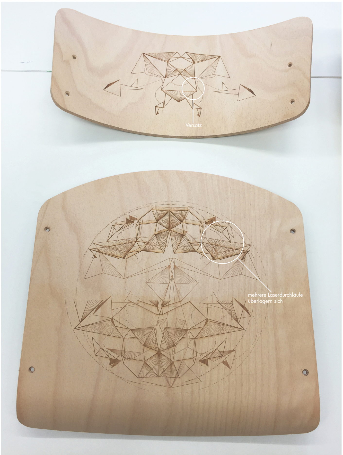
Abbildung33: Die Sitzfläche wurde nach einer fehlerhaften Bearbeitung als Versuchsobjekt genutzt, um passende Laserparameter zu finden. Die Rückenlehne (Abbildung 29) hat einen Versatz in der Grafik, da das Objekt bei der Einstellung des Fokus verrückt wurde.
