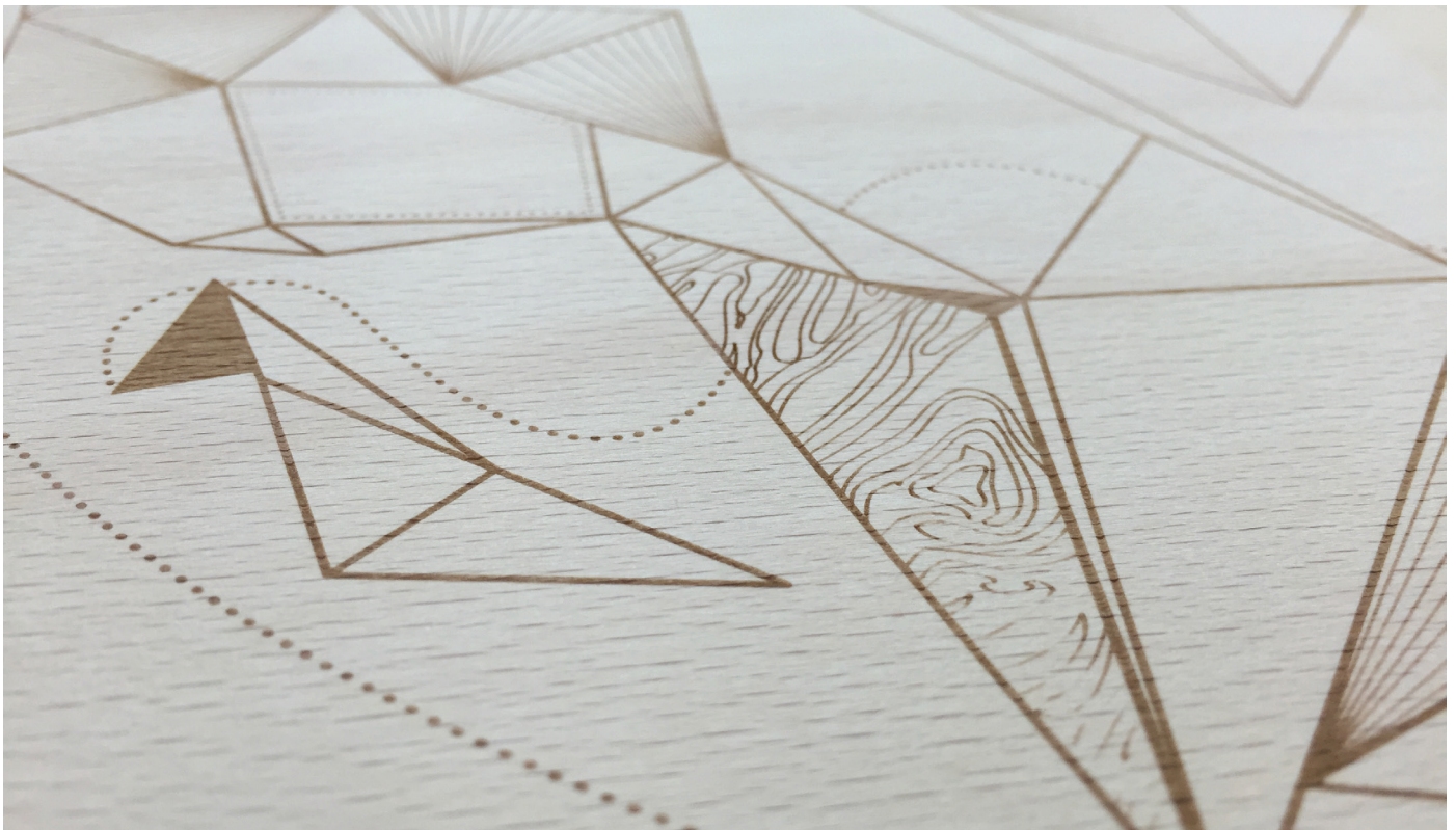
Abbildung31: Fehlerstelle; ein Teil der Grafik wurde nicht sauber übertragen. Der Grund hierfür lag bei der Einstellung des Fokus.
