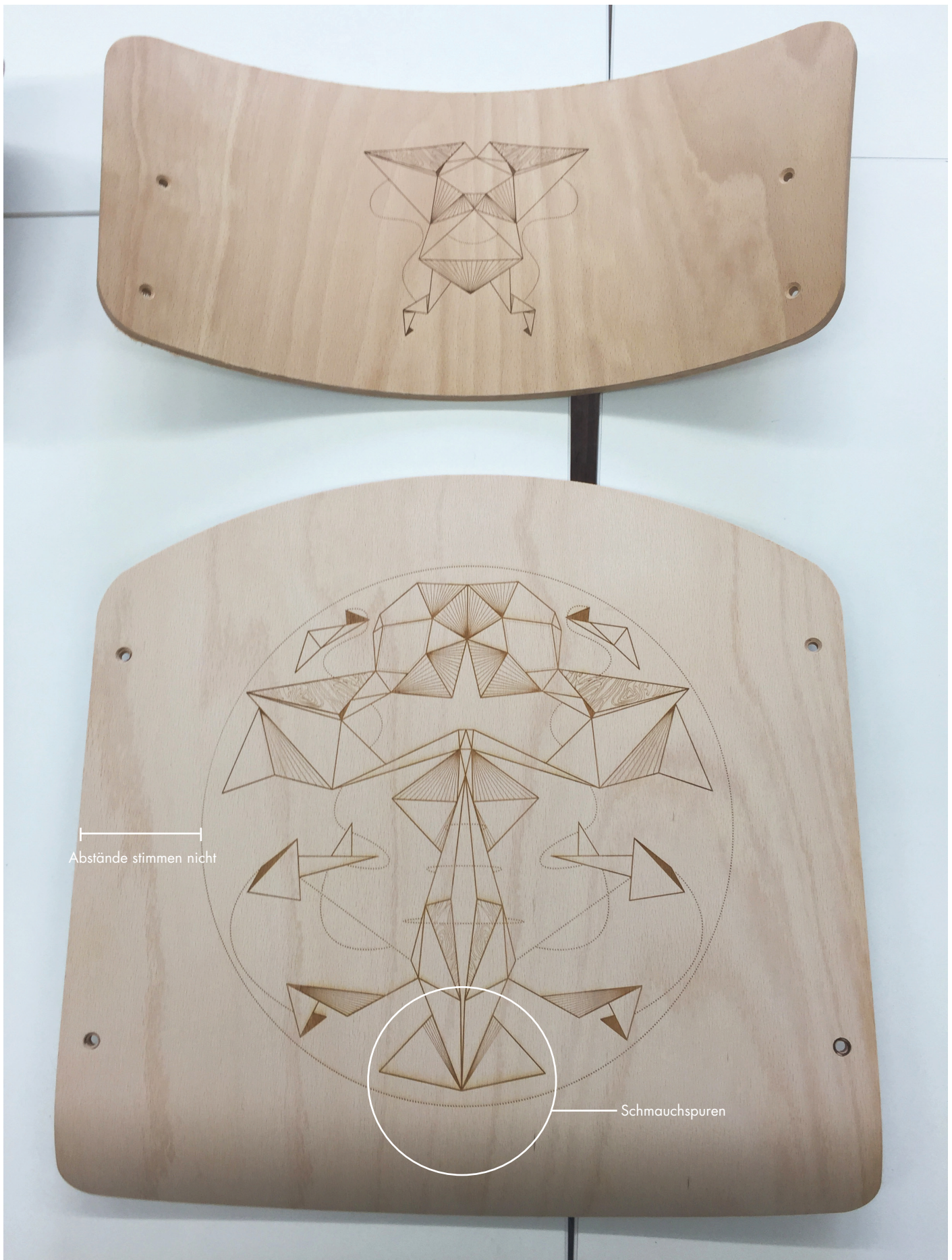
Abbildung32: Fehldurchlauf; Die Grafik auf der Sitzfläche ist nicht genau mittig positioniert und durch nicht perfekt eingestellte Laserparameter entstanden ungewollte Schmauchspuren. Die Grafik auf der Rückenlehne ist nicht final und konnte durch Bewegen des Objektes nicht ohne Versatz weiter bearbeitet werden.
