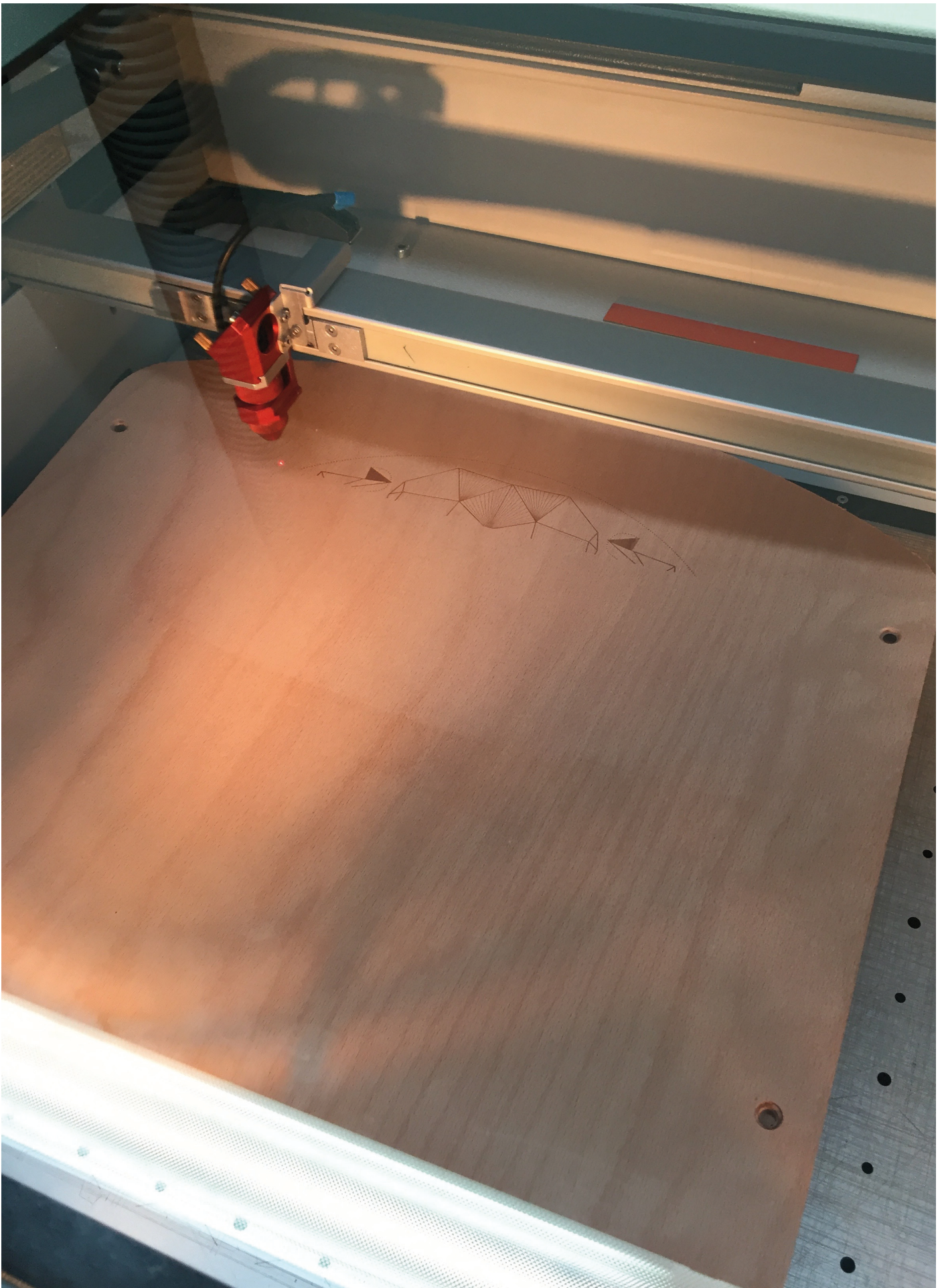
Abbildung 26: Erster Test auf der Sitzfläche. Ein Problem hierbei war die Positionierung, so dass die Grafik mittig auf der Oberfläche platziert ist.
